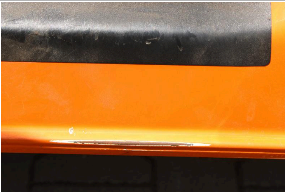
Bild: 17 Beschädigte Lackierung im Einstieg des Fahrzeugführers.
