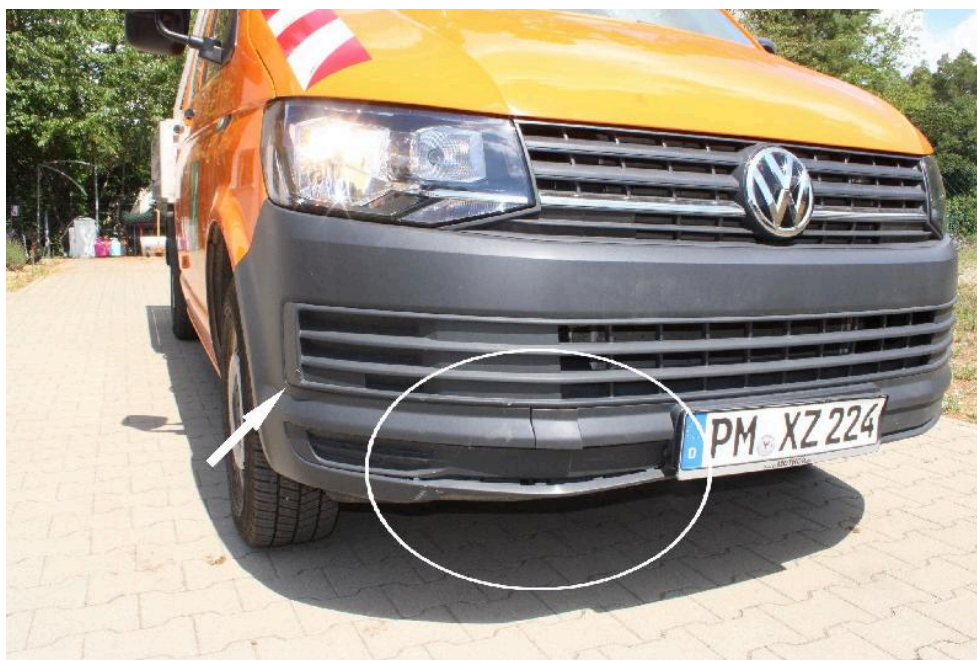
Bild: 11 Die Stoßfängerabdeckung ist vorn rechts stark beschädigt.
