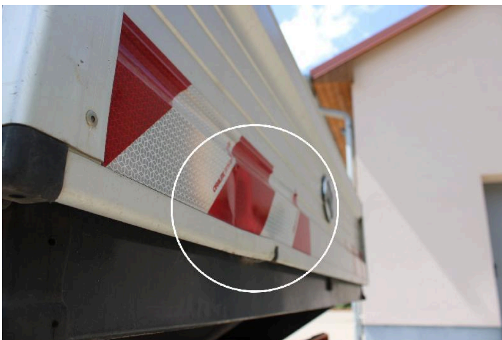
Bild: 13 Die Heckklappe ist hinten links leicht eingedrückt.
