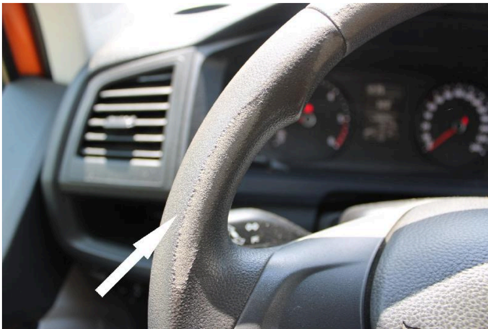
Bild: 20 Der Schaumstoff des Lenkrades ist abgenutzt und lose.
