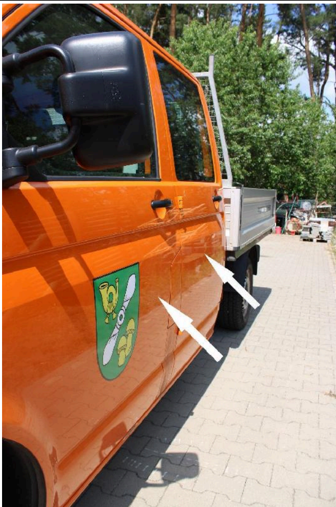
Bild: 15 Fahrertür und Tür hinten rechts haben ebenfalls kleine Dellen
