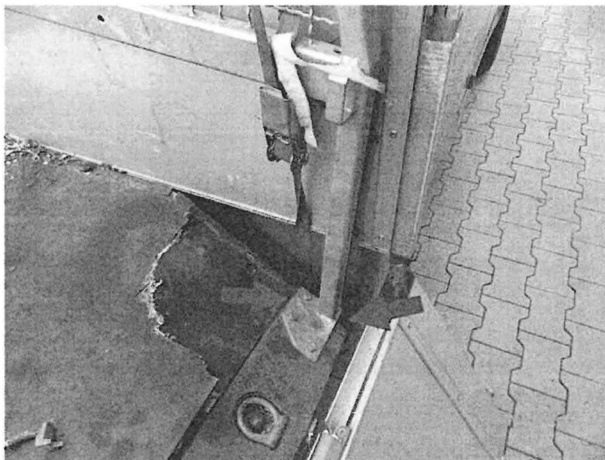
Fuß Schutzgitter rechts verbogen
