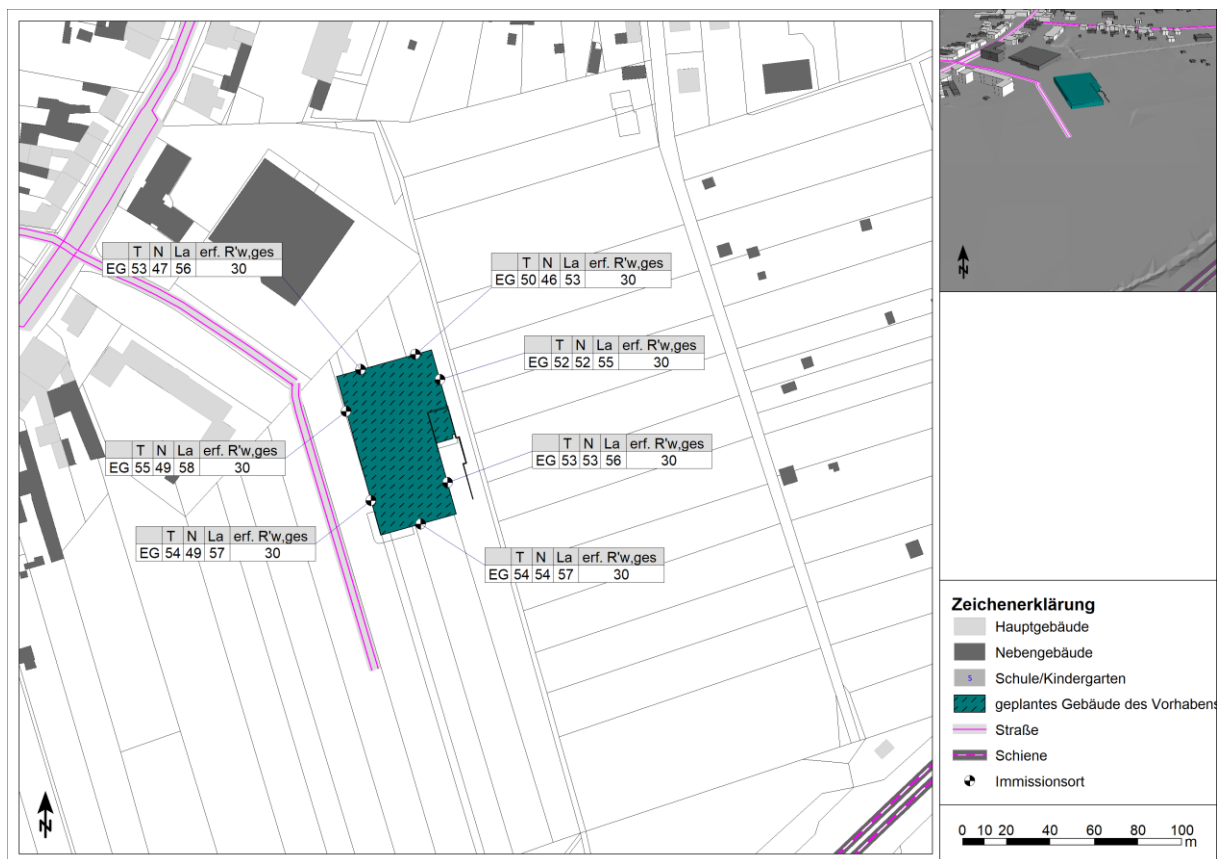
Abbildung 17: Pegeltabellen mit Beurteilungspegeln tags/nachts, maßgeblicher Außenlärmpegel und erforderliches bewertetes Schalldämm-Maß des Gesamt-Außenbauteils für Büronutzung am Vorhaben
