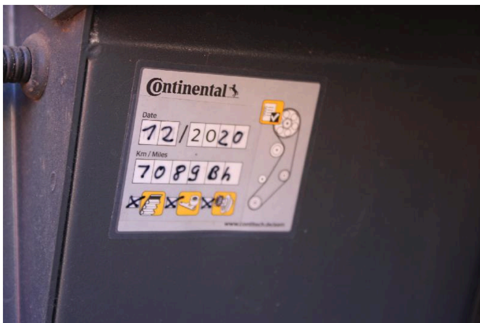
Bild: 14 letzter Zahnriemenwechsel
