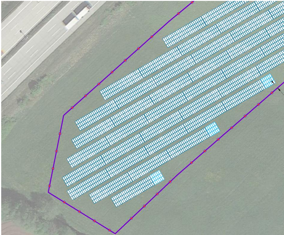
Abbildung 29: Angepasstes Parklayout der geplanten PV-Module und Tischreihen mit einem Azimutwinkel von 150° (bei: 0° Norden, 180° Süden). Das neue Parklayout ist somit „blendfrei“ (Quelle: Auftraggeber)
