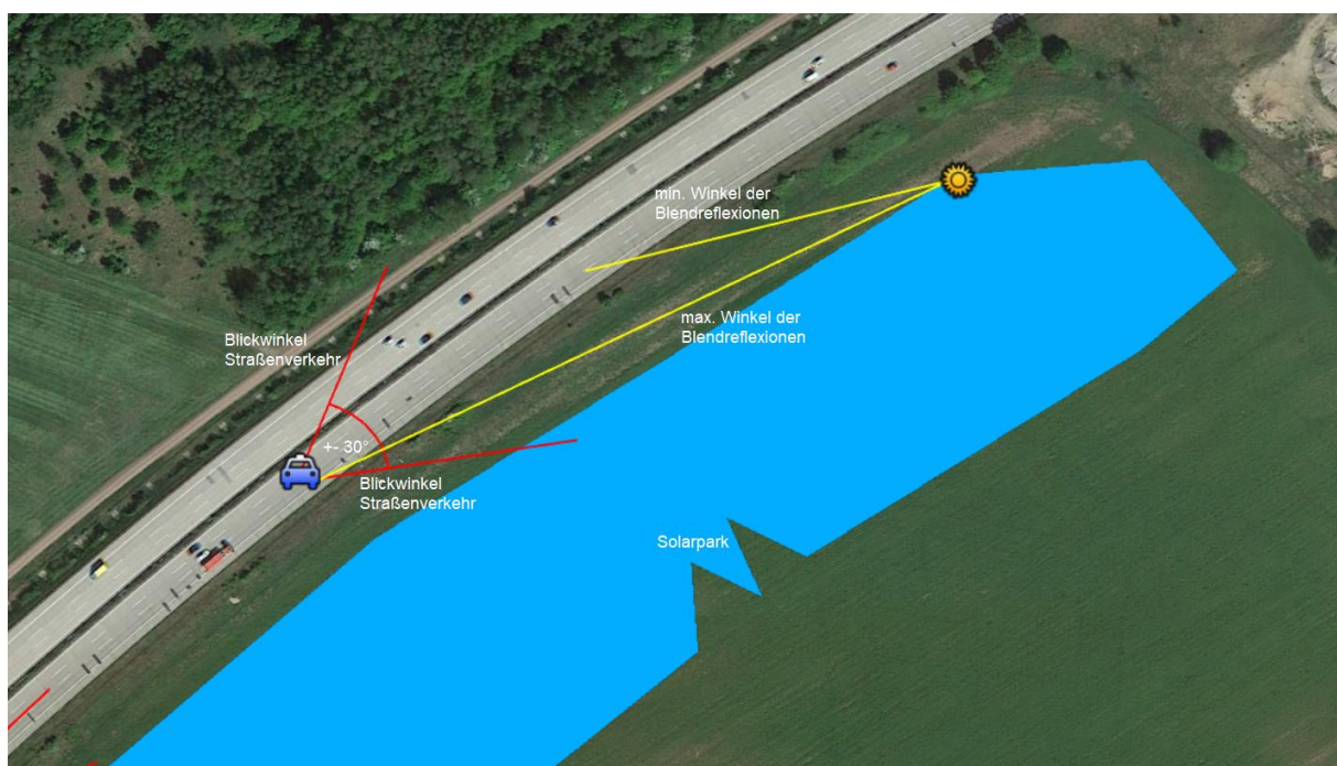
Abbildung 23: Blendreflexionen, ausgehend von dem Solarpark, in Richtung Westen. Dargestellt ist der nördlichste Punkt innerhalb des Solarparks, welcher Blendung in Richtung des Straßenverkehrs verursacht. Weiterhin zu sehen sind die simulativ ermittelten Winkel der Blendreflexionen in Richtung der BAB 9. Die roten Linien stellen den Blickwinkel ( \pm 30^\circ ) des Straßenverkehrs dar.
